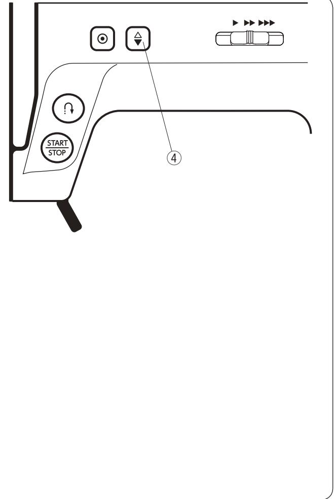
**④ Кнопка подъёма/опускания иглы**
