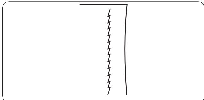
Этот узкий шов разработан для устраниния складок на трикотажных тканях и при пришивании косой бейки, чтобы шов можно было полностью раскрыть и сделать плоским.
