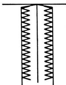
Простой зигзаг используется для обработки (обмётки) краёв большинства тканей во избежание осыпания.
