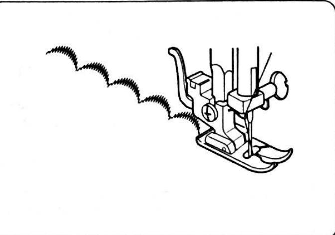
Атласные стежки используются для декоративной отделки одеял, скатерей, салфеток. При уменьшении длины стежка делайте пробную строчку, чтобы обеспечить плавную подачу ткани.
