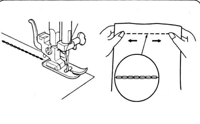
Эта строчка формируется из двух прямых стежков и одного обратного. Такой шов нелегко разорвать. Используйте его в области проймы и втачивания рукавов. Можно также использовать при шитье рюкзаков для повышенной прочности.
