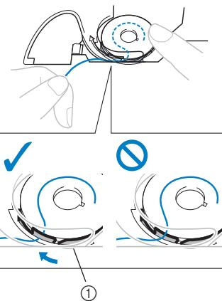
① Пружина регулировки натяжения нити
