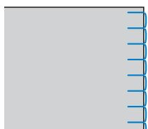
При проходе угла остановите машину так, чтобы игла была опущена в материал немного за краем аппликации, поднимите рычаг прижимной лапки и поверните материал, чтобы изменить направление шитья.
