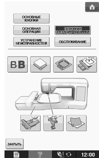
При нажатии кнопки **ОСНОВНАЯ ОПЕРАЦИЯ ВЫШИВКИ** отображается информация об установке вышивального модуля, замене лапок для вышивания, подготовке материала к вышиванию, проверке натяжения нитей и т. д.
