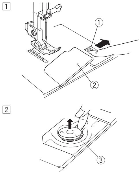
1 Отодвиньте кнопку снятия челночной пластины вправо и снимите челночную пластину.
