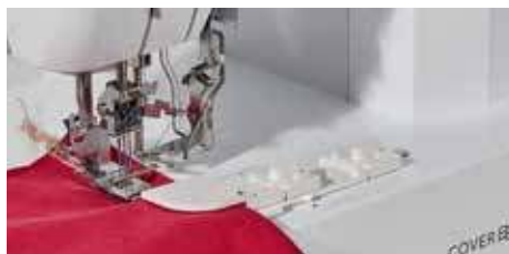
Приспособление для подшивания края Подшивание края одинарной или двойной подгибкой.
