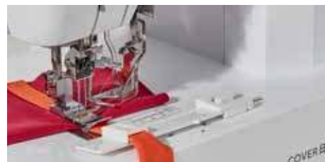
Приспособление для пристрачивания косой бейки Пристрачивание косой бейки шириной 12 мм.
