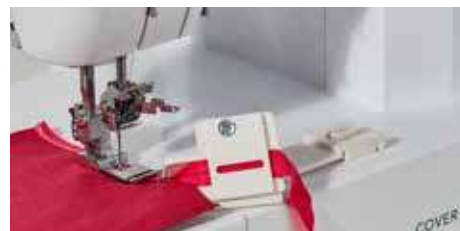
Приспособление для окантовки срезов косой бейкой Окантовка срезов косой бейкой шириной 6 мм и 12 мм.
