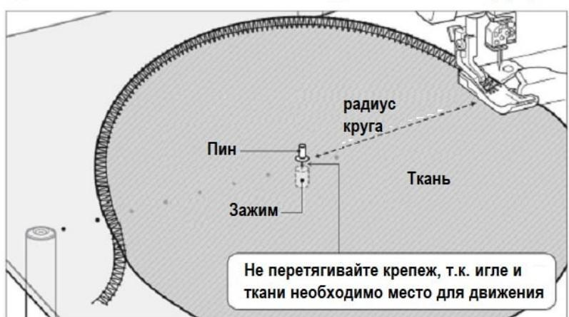
Универсальные отверстия на столе позволяют использовать разные диаметры круга для различных проектов. Снимите зажим с пина. Вставьте пин в нужное отверстие. Используйте зажим для закрепления пина внизу стола.
