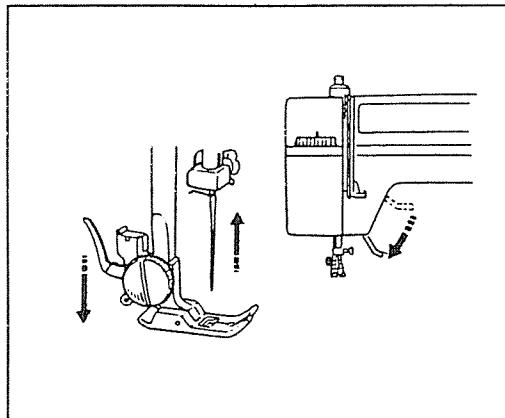
Поворачивая маховое колесо в направлении к себе, поднять иглу вверх и опустить нажимную лапку вниз.
