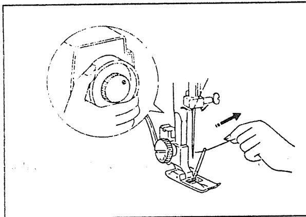
② Осторожно поворачивая маховое колесо правой рукой в направлении к себе, опустить иглу вниз, после этого продолжать поворот махового колеса до получения крайнего верхнего положения нитепрятягивательного рычага. Слегка вытянуть игольную нитку с образованием петли шпульной нитки.
