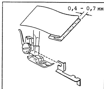
Подгибать ткань вкладку на требуемую ширину и прикрепить ее шпилькой. Затем перегибать подогнутый край, как показано выше. Опустить нажимную лапку, затем ослабить затяжку винта крепления держателя лапки и установить специальное загибочное приспособление размещено в середине носиков нажимной лапки.
