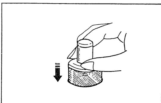
Для увеличения давления лапки на ткань нажать на кнопку регулятора до такого положения, чтобы получить нужное давление.
