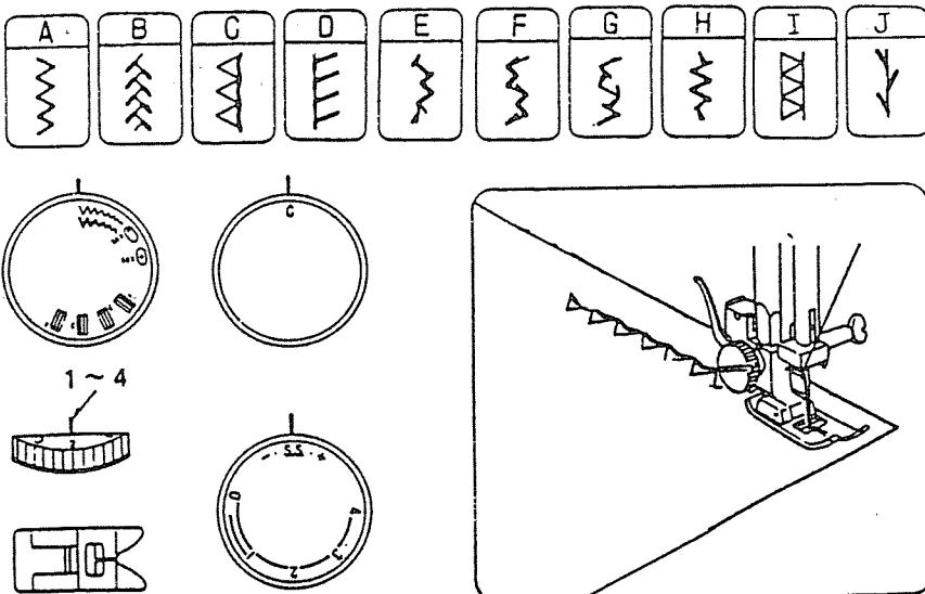
В случае, если не балансируются подачи ткани вперед и назад в зависимости от вида ткани, надо корректировать баланс, поворачивая ручку регулировки длины стежком:
