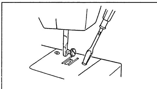
Снять иглу и нажимную лапку.
