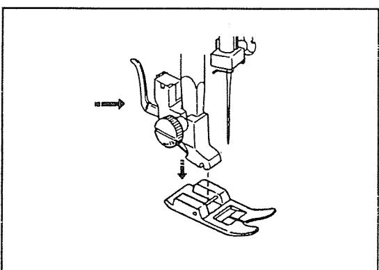
При прикреплении нажимной лапки, заранее установить кнопку регулятора давления лапки в нажатое, крайнее нижнее положение.
