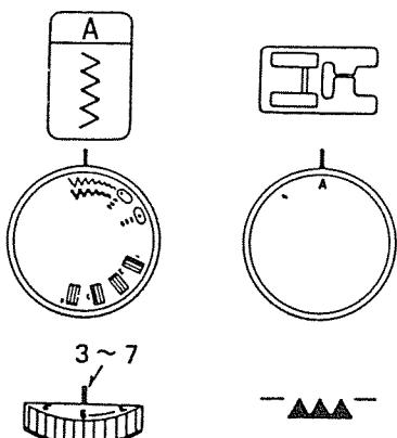
Прикрепить пуговицу лентой по меткам, определяющим место ее расположения на ткани. Для образования ножки пуговицы можно поместить шпильку в конце лапки. Нажать рычаг вертикального перемещения зубчатых реек и, переместив рычаг вправо, опустить зубчатые рейки.
