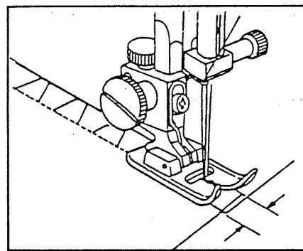
Настоящая строчка применяется для соединения бортовок из тяжелой ткани. Перекрывать два края внахлестку и соединить бортовки строчкой.
