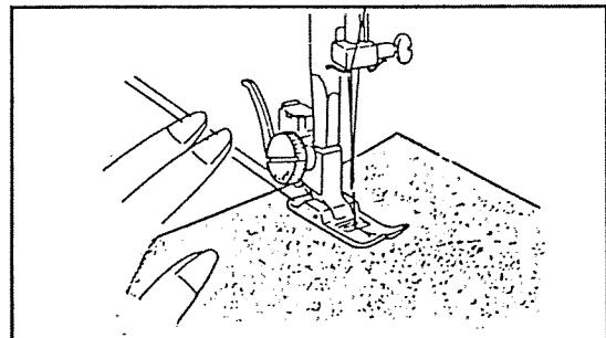
Поднять нажимную лапку и расположить сшиваемую ткань рядом с контрольной линией игольной пластиинки.
