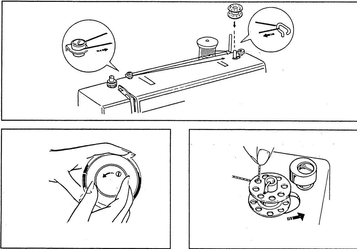
Вытянуть конец нитки с катушки, пропустить нитку через нитенаправитель на верхней крышке машины, провести нитку по нитенаправителю моталки и ввести нитку в отверстие шпульки изнутри наружу. Надеть шпульку на шпиндель моталки и прижать ее вправо.
