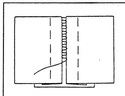
Загнуть край каждой соединяемой штуки ткани на 1,5 см и заутюжить края. Прикрепить две штуки ткани к бумажной или тканевой подкладке в расстоянии между краями 0,2 - 0,3 см. Выполнить строчку, осторожно направляя ткань, чтобы надежно соединить два ряда стежками.
