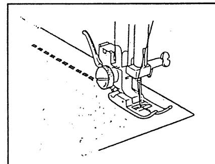
Строчка выполняется с двумя стежками вперед и одним стежком назад с обеспечением прочного неравнорвавшегося шва.
