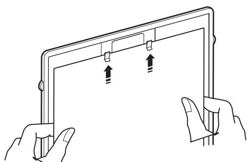
Поверните таблицу строчек обратной стороной и пользуйтесь зажимами для закрепления швейных инструкций, заметок и т.п.
