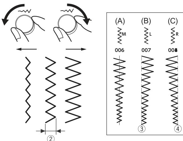
(A): Строчка 006 имеет фиксированное центральное положение иглы. При регулировке ширины зигзаг будет изменяться симметрично относительно центральной линии.
