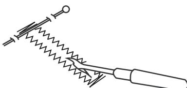
6 Петля выполняется автоматически в порядке, показанном на рисунке. Когда петля будет готова, машина автоматически остановится с иглой в верхнем положении. Нажмите кнопку обрезки нити и удалите ткань.
