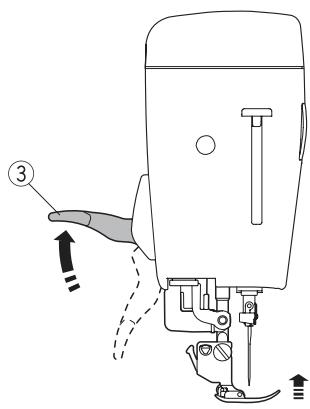
Поднимите иглу в верхнее положение кнопкой ① и поднимите рычаг прижимной лапки.
