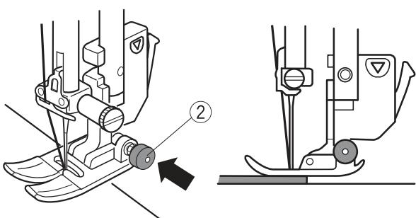
Нажмите на педаль или на кнопку «старт/стоп» ① чтобы начать шить. Слегка направляйте край ткани вдоль направляющей линии на игольной пластине. Не тяните ткань вперед или назад.
