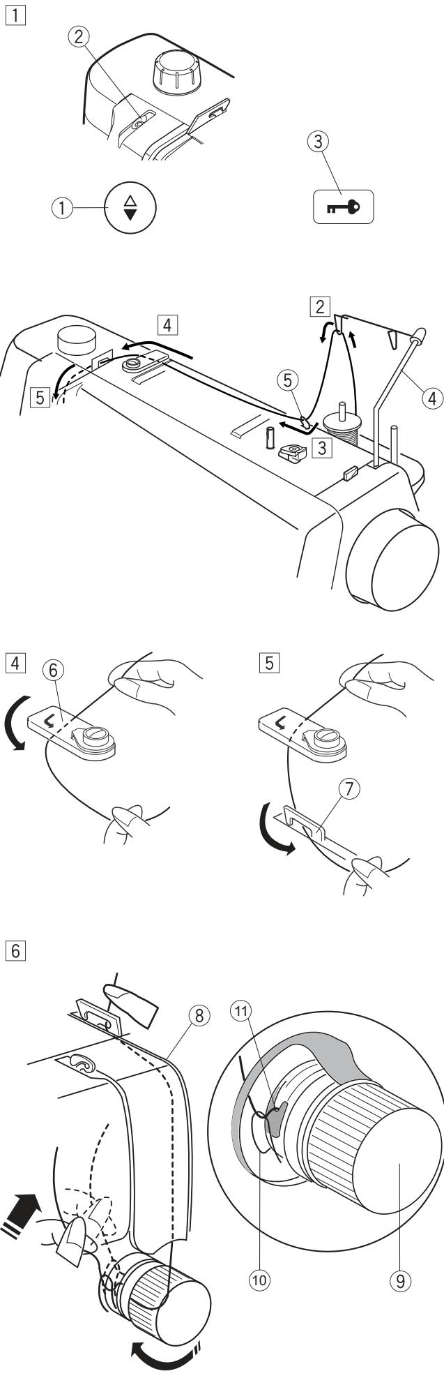
Нажмите на клавишу подъёма/опускания иглы ① и поднимите иглу в верхнее положение.
