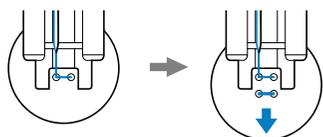
**8** Поверните маховик машины на себя (против часовой стрелки) и убедитесь в том, что игла правильно входит в два отверстия в пуговице. Если кажется, что игла ударит по пуговице, измерьте расстояние между отверстиями еще раз. Настройте ширину строчки так, чтобы она была равна расстоянию между отверстиями в пуговице.
