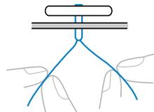
**11** Закончив пришивание пуговицы, установите переключатель положения гребенок транспортера на **▲▲** (вправо, если смотреть сзади), чтобы поднять гребенки транспортера.
