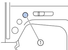
① Кнопка позиционирования иглы (Подъем/опускание иглы)
