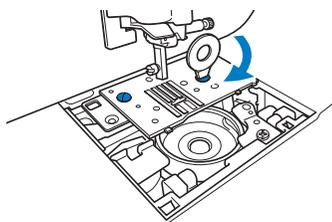
Поверните маховик и проверьте, что гребенки транспортера двигаются плавно и не касаются краев вырезов на игольной пластине.
