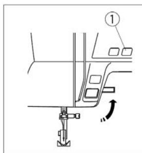
Поднимите прижимную лапку. Нажмите кнопку поднимания/опускания иглы
