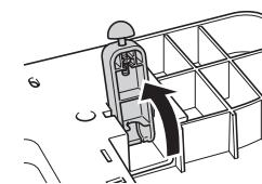
① Klappen Sie die Beine auf der Unterseite des Maxi-Anschiebetisches aus.
