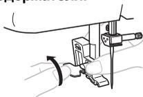
**4** Отверткой выверните два винта. Поднимите игльную пластину, как показано на рисунке, и затем сдвиньте игльную пластину влево, чтобы снять ее.
