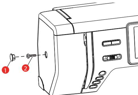
> Снимите крышку головки машины (3).
