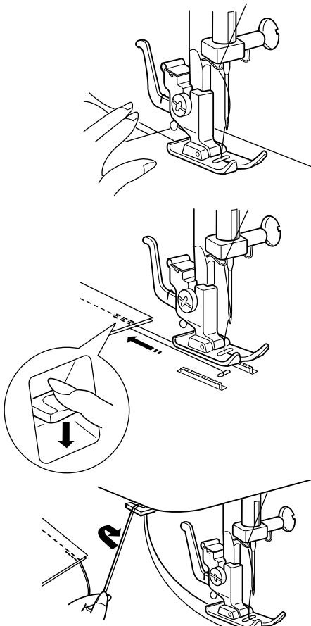
1 Поднимите прижимную лапку и расположите ткань так, чтобы ее край был выровнен по разметочной линии шва на игольной пластинке. Опустите иглу на ткань. Опустите прижимную лапку и разгладьте нитки назад. Нажмите педаль. Слегка направляйте ткань вдоль разметочной линии шва так, чтобы ткань перемещалась сама.
