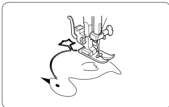
Наметайте (или наклейте термосеодинителем тканей) части аппликации на ткань. Срочите вокруг аппликации, следя за тем, чтобы игла входила вдоль внешнего края аппликации. При шитье на углах опустите иглу в ткань. Поднимите прижимную лапку и поверните ткань вправо или влево.
