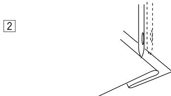
2 Расположите ткань так, чтобы игла только пробивала край складки в крайнем левом положении.
