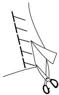
Этот трикотажный стежок идеально подходит для шитья купальных костюмов и эластичного велюра, т.к. он обеспечивает самую высокую степень эластичности и прочности. Расположите ткань так, чтобы обеспечить шов 1,6 см. После прошивки обрежьте припуск на шов. Страйтесь не порезать строчку.
