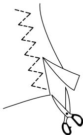
Этот стежок используется для отделки необработанного края синтетических и других тканей, которые могут морщиться. Расположите ткань так, чтобы обеспечить шов 1,6 см. После прошивки обрежьте припуск на шов. Страйтесь не порезать строчку.
