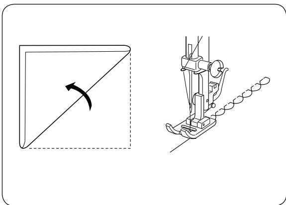
Используйте тонкую ткань (например, трикотаж). Сложите и прострочите по косой линии. Если игла отклоняется вправо, дайте ей лишь слегка коснуться сложенного края ткани. После шитья раскроите ткань и загладьте складки на одну сторону.
