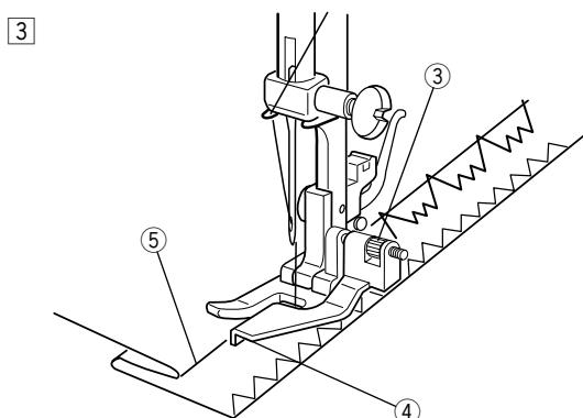
3 Поверните винт направляющей, чтобы отрегулировать совмещение направляющей с краем складки.
