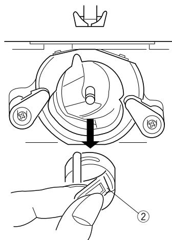
При установке шпульного колпачка установите челнок в паз челночного механизма.
