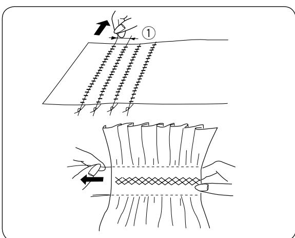
Выберите длину стежка «4», прострочите прямые строчки на расстоянии 1 см друг от друга поперек части, где будут буфы. Завяжите нитки вдоль края. Потяните за шпульные нитки, чтобы равномерно распределить складки. Зафиксируйте нитки на другом конце. Прострочите декоративный стежок между сборочными стежками. Вытяните сборочные стежки.
