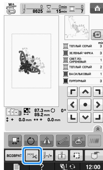
**2** Для выключения функции автоматической обрезки нити нажмите кнопку .
