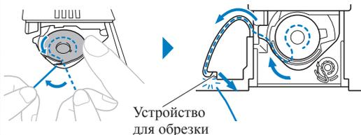
\* Направление заправки нижней нити обозначено стрелками на игольной пластине.
