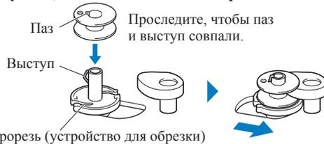
\* Проверьте ориентацию шпульки по символу "b" на боковой поверхности шпульки. Устанавливая шпульку в шпульный колпачок, сохраняйте такую же ориентацию.
