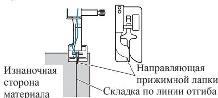
**11** Отрегулируйте ширину строчки так, чтобы строчка немного захватывала складку. (с. 15)
