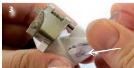
> Montar la suela deseada deslizándola por la guía hacia arriba hasta que se encaje.
