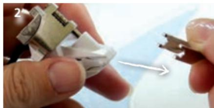
⇒ 取り付けられている押え底を斜め下へ引っ張り、はずします。
