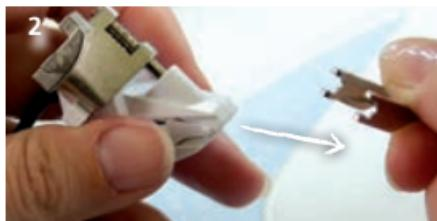
⇨ Вытяните в сторону и вниз вмонтированную подошву лапки из направляющей.
