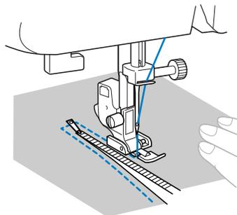
**5** Для пришивания противоположной стороны застёжки «молния» отсоедините лапку, нажав кнопку, расположенную на задней части прижимной лапки, расположите лапку на другой стороне застёжки «молния» и продолжите шитье, используя паз на другой стороне.
