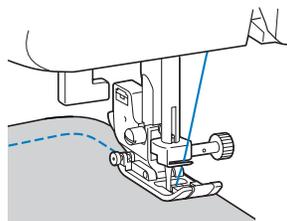
При шитье вдоль кривой линии с использованием строчки зигзаг уменьшите длину стежка, чтобы получить более красивую строчку.
