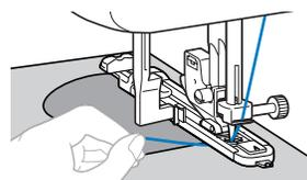
► По завершении шитья машина автоматически прошивает усиленные стежки, а затем останавливается.
