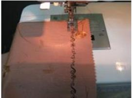
Расширьте возможности при помощи вертикального отображения строчек. Выберите строчку №112F, начните шить, нажмите на кнопку автоматической закрепки, машина выполнит фрагмент строчки до конца и остановится. Если нажать на кнопку вертикального отображения после выбора строчки, она будет перевернута по вертикали. Строчки, к которым применима эта функция, отмечены буквой F на панели подсказок.
