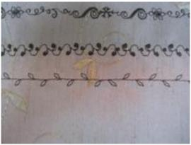
Разнообразить строчки можно с помощью зеркального отображения. Если выбрать кнопку зеркального отображения, строчка будет перевернута по горизонтали. Выберите строчку №105, начните шить, нажмите на кнопку автоматической закрепки, машина выполнит фрагмент строчки до конца и остановится. Нажмите на кнопку зеркально отображения, строчка будет перевернута по горизонтали.
