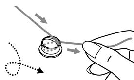
3. Обведите нитку по часовой стрелке вокруг регулятора предварительного натяжения.
