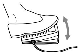
Кабель пусковой педали подсоединяется к соответствующему разъему выключенной машины.
