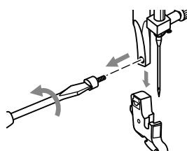
Полностью ослабьте винт на стержне лапкодержателя (поворачивая против часовой стрелки) и стяните лапкодержатель.
