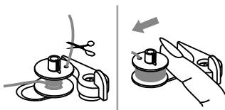
8. Остановите моталку после намотки пары витков и обрежьте конец нитки вплотную к отверстию шпульки. Продолжайте намотку до заполнения шпульки. Моталка остановится автоматически, как только шпулька будет заполнена. Остановите машину. Отведите шпульку влево.
