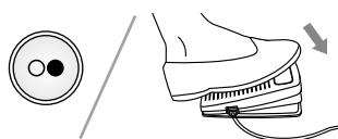
7. Процесс намотки запускается нажатием пусковой педали или кнопкой Start/Stop.
