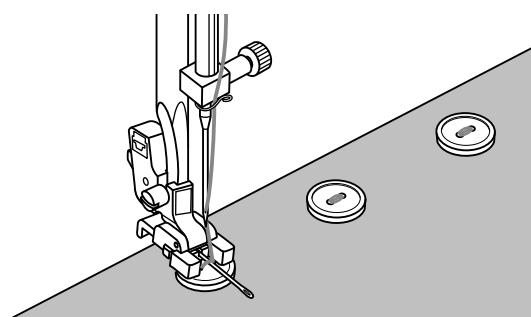
Перед шитьем нажмите кнопку "Автоматическое закрепление строчки". Таким образом, нитки будут закреплены в начале и конце шитья.
