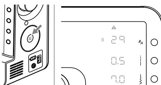
Нажмите кнопку Set/disp, чтобы включить функцию отражения и запомнить ее.
