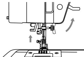
Поднимите рычаг прижима ткани, чтобы перевести стержень лапкодержателя в верхнее положение.
