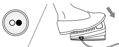
Для того, чтобы прошить выбранные стежки, нажмите кнопку **start/stop** или педаль ножного пускателя.
