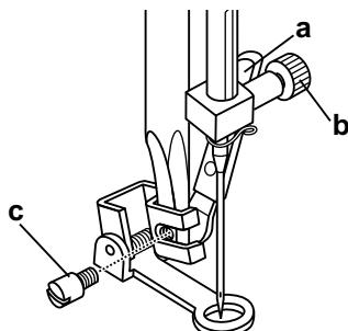
Снимите лапкодержатель и установите лапку для штопки.
