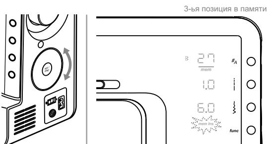
С помощью селекторного колеса найдите функцию добавления данных в память (mem insert).
