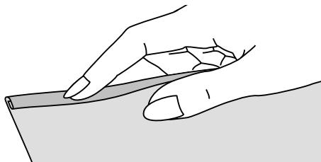
Край ткани подворачивается на 3 мм и затем еще раз на 3 мм на участке около 5 см..
