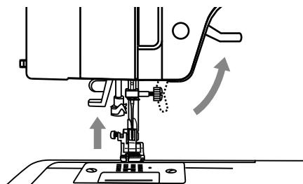
Лапка опускается и поднимается рычагом прижима ткани.
