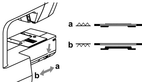
Передвиньте ползунок в положение "~~~~", чтобы опустить транспортер.
