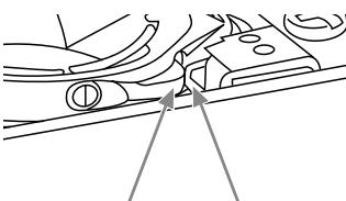
Снова установите капсулу челнока в челночный паз так, чтобы носик челнока (a) прилегал к стопору (b). Установите на место игольную пластину и закрепите винтами. Вставьте шпульку. Закройте крышку челнока. Опустите лапку.
