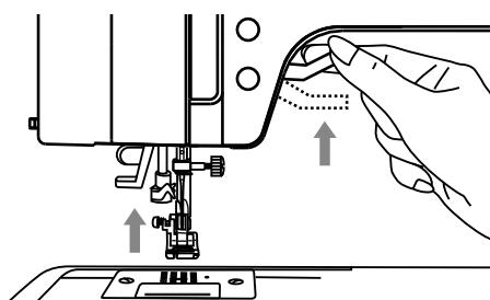
При работе с несколькими слоями толстого материала лапку можно поднять на вторую высоту, отжав рычаг до отказа вверх. Таким образом, под лапку можно подложить толстый материал.
