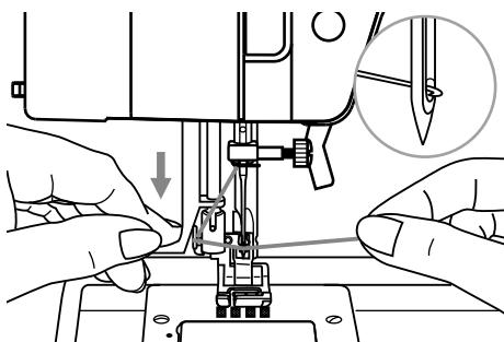
Нитевдеватель автоматически повернется в положение заправки нитки, а крючок пройдет через ушко иглы.
