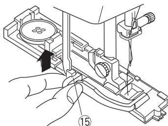
5 Запустите машину и обработайте петлю. Петля выметывается автоматически. Несколько первых стежков машина выполняет медленно,
