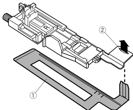
1 Вставьте выступ стабилизирующей пластины ① в прорезь ② лапки для петли-автомата.
