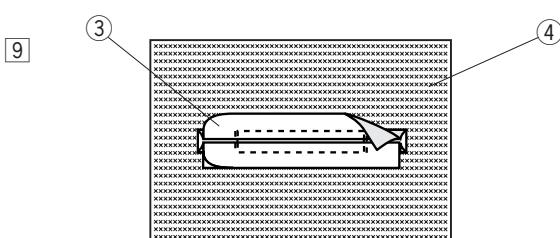
9 Нашивку следует обрезать на расстоянии 1–1,5 см (7/16–5/8 дюйма) от отверстия. Углы следует обрезать с закруглением, как показано на рисунке.
