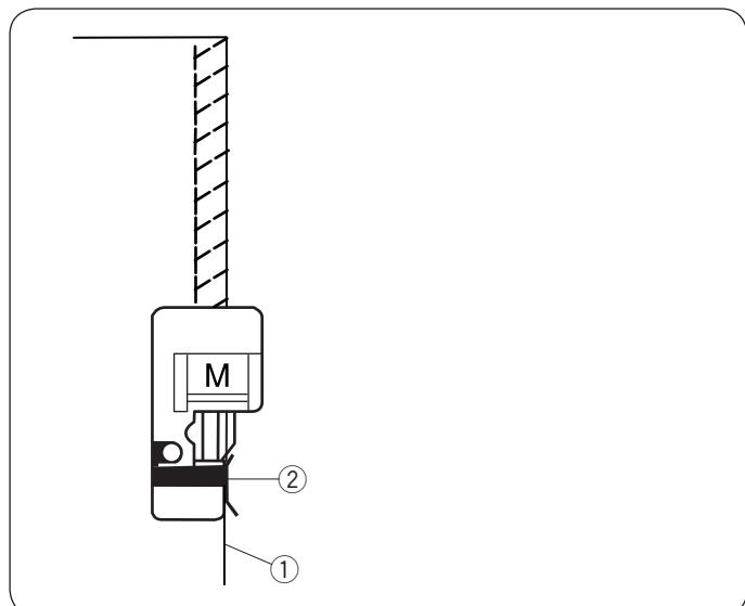
Этот стежок рекомендуется использовать для сшивания таких тканей, как синтетические трикотажные ткани и эластичный велюр, т. к. он обеспечивает самую высокую степень эластичности и прочности.
