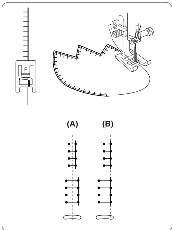
Расположите аппликацию на ткани и приметайте ее или используйте плавкий стабилизатор, чтобы закрепить аппликацию.
