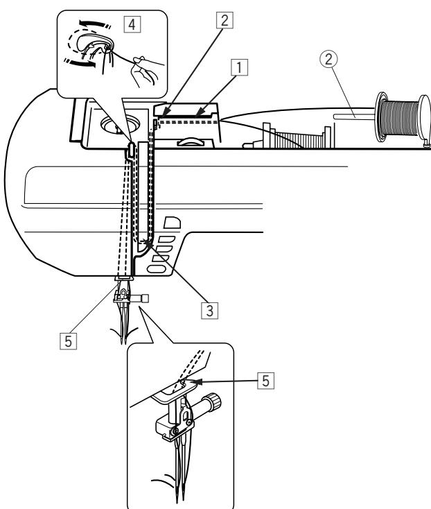
Вставьте дополнительный катушечный стержень в отверстие рядом с горизонтальным стержнем катушки.
